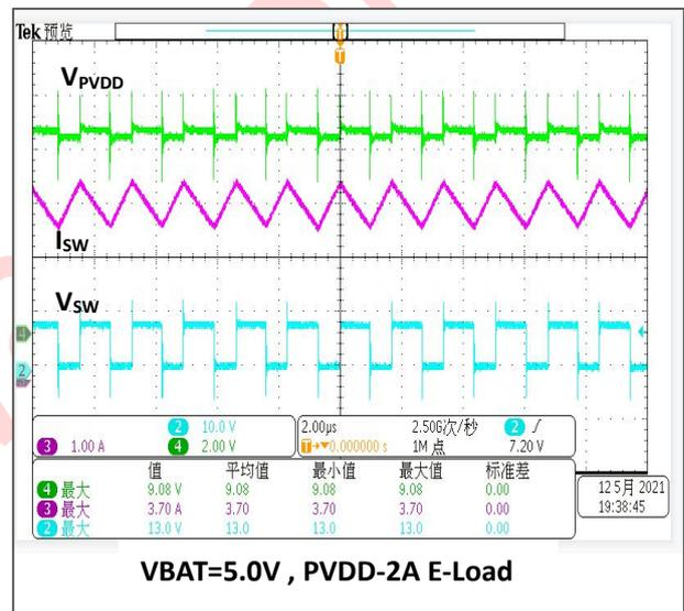
测试条件:  $R_{IN\_EXT}=0\ \Omega$ ,  $C_{IN\_EXT}=105$ ,  $V_{BAT}=104//470UF$ ,  $L_m=4.7\ \mu H$ ,  $PVDD=104//470UF$ , Sine-1KHZ-Input:
